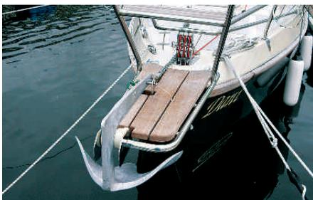
**Sinnvoll: Ein breiter Stahlbügel bildet eine Kombination aus Bugtritt und Ankergalgen**
