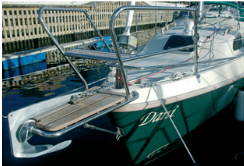
Die auffällige Bugplattform trägt nicht nur den Anker, sondern dient zudem als bequeme Einstiegshilfe
