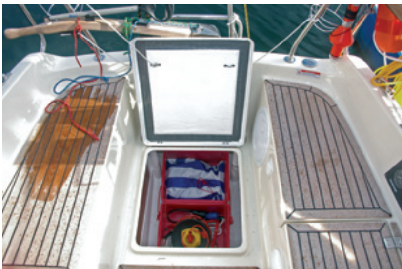
Das Cockpit strahlt dank der hohen Süllkanten und der sorgsam verarbeiteten Teakflächen auf Antrieb eine gewisse Geborgenheit aus – und bietet zudem mehrere ebenso praktische wie seegerechte Staumöglichkeiten
