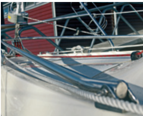
Der zweibeinige Jüttbaum auf dem Vorschiff erlaubt ein einfaches Mastlegen und erhält dabei dessen Stabilität nach vorn aufrecht
