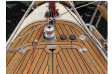
Smart ist der in Stahl gefasste Bugtritt
